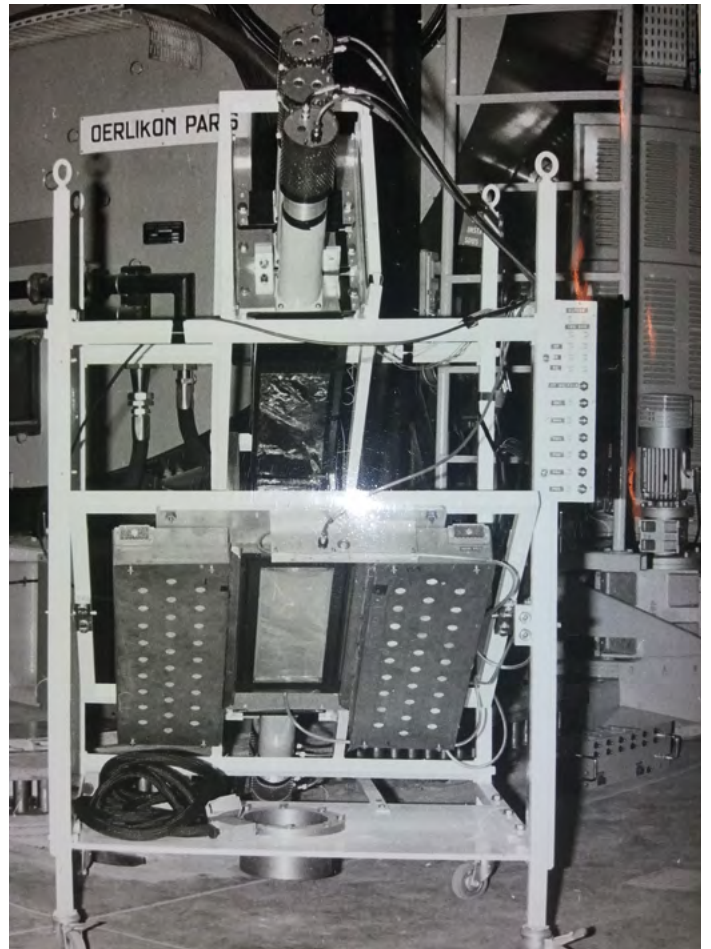
2. Ensemble de détection installé dans le plan focal d'un spectromètre magnétique pour la détection des pions positifs \pi^+ . Derrière les scintillateurs, on distingue la chambre de 128 fils permettant de mesurer l'énergie des \pi^+ .
