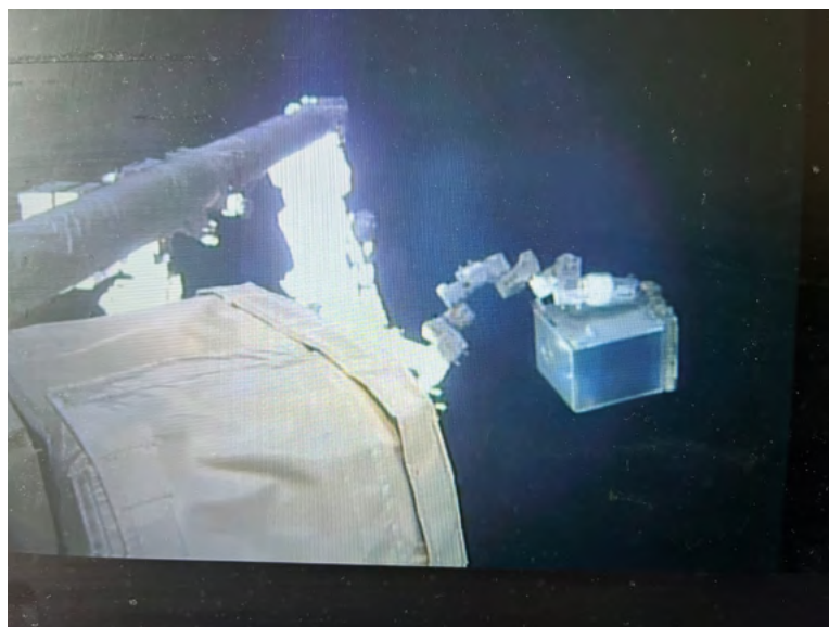
Le bras robot-manipulateur de la station spatiale internationale actionné par un astronaute installe la plateforme ACES sur le module européen Columbus le 21 avril 2025. ACES ( Atomic Clock Ensemble in Space ) contient une horloge à atomes froids de rubidium PHARAO et un maser à hydrogène ultrastables, destinés à des tests de physique fondamentale.
