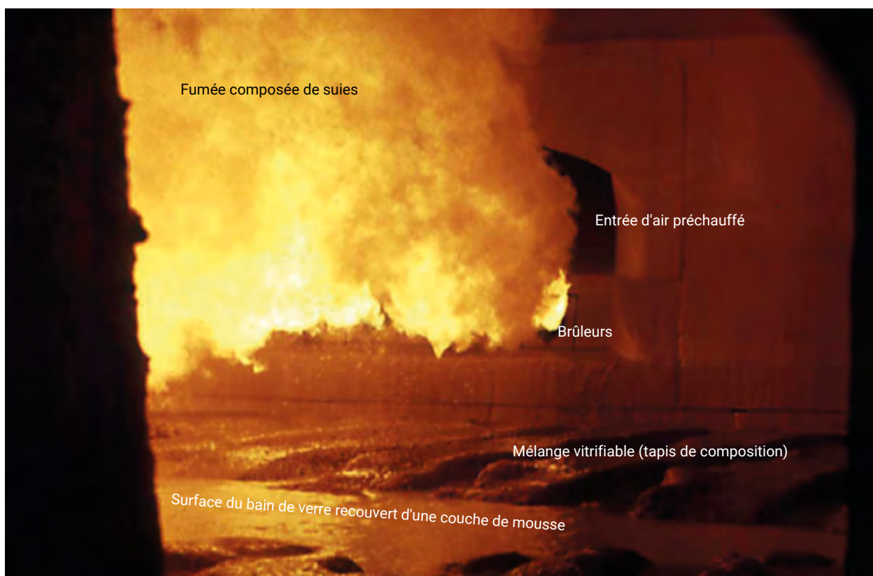
1. Vue de l'intérieur d'un four verrier avec, à la surface du bain, une couche correspondant à la matière première, où se trouve aussi une écume formée par le dégazage. Au-dessus du bain de liquide, des flammes provenant de la combustion d'un gaz et de l'air produisent l'énergie nécessaire à la fusion.
