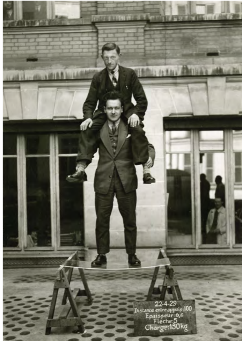
1. Deux chercheurs du centre de recherche de Saint-Gobain testant la résistance mécanique d'une plaque de verre, en 1929.
