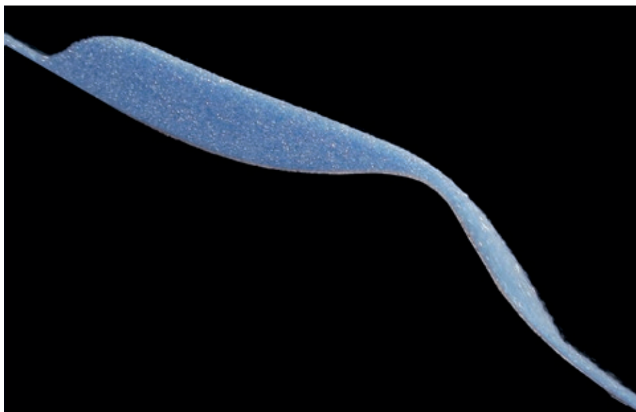
3. Expérience de laboratoire illustrant la formation d'un choc stationnaire au sein d'un écoulement granulaire. Le choc est créé par l'ajout de particules en amont de la bosse, qui vont ralentir l'écoulement lors de l'impact. (D'après Viroulet et al. [4]).
