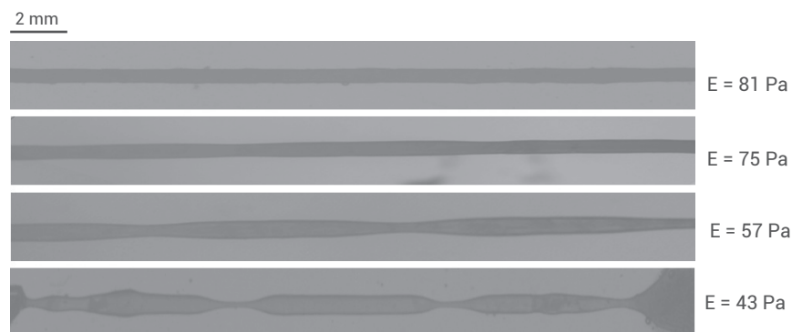
2. Modulation longitudinale spontanée de cylindres de gel. Quatre cylindres en gel d'agar-agar, de différents modules de Young E et de rayons identiques ( r_0 = 240 \mu\text{m} ) sont placés dans du toluène liquide. Le cylindre le plus rigide reste droit, tandis que des modulations du rayon apparaissent spontanément et se figent pour les cylindres plus souples.
