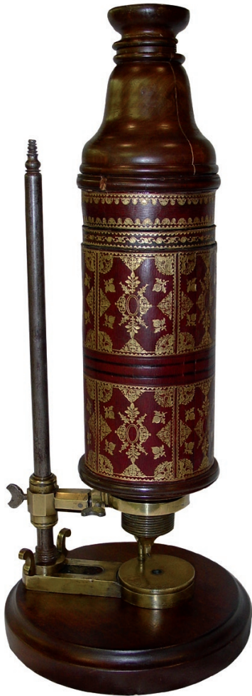
1. Microscope construit à Londres par Christopher Cock pour Robert Hooke. On pense que Hooke a utilisé ce microscope pour les illustrations de son ouvrage, Micrographia . (The Billings Microscope Collection, National Museum of Health and Medicine, USA.)
