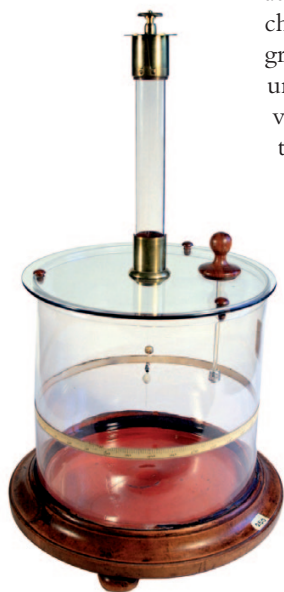
2. Une expérience discutée, la détermination de la force électrique (1785) : une balance de Coulomb.
