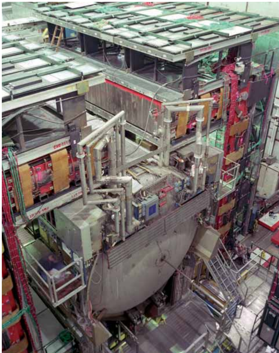
Le détecteur DØ. On voit les chambres à muons (plates, extérieures, en haut de la photo) entourant le cryostat cylindrique qui contient le calorimètre à argon liquide.
