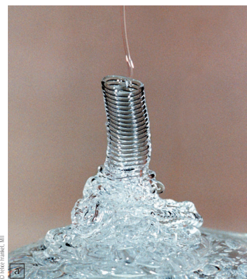
1. Instabilités de flambage dans les fluides visqueux. (a) Enroulement d'un filet d'huile de silicone. (b) Repliement périodique d'une nappe de chocolat fondu.
